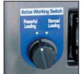
para la operación que vaya a realizar. El interruptor de trabajo activo tiene dos modos: carga potente o carga normal. En el modo de carga potente se puede aumentar y reducir cuando sea necesario el caudal hidráulico que va hacia el equipo de trabajo. En el modo de carga normal todo el caudal hidráulico se transfiere directamente al equipo de trabajo.
