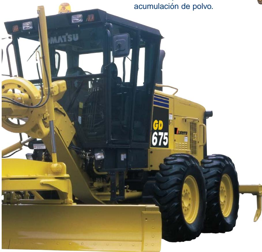
El motor diesel Komatsu SA6D114E, turboalimentado y postenfriado, proporcionan 149 kW 200 HP para las aplicaciones más exigentes.
